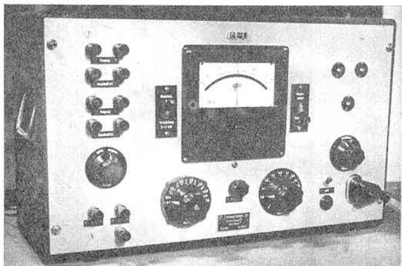
Vierpolmeßgerät Typ VPM 1 zur Dämpfungs- und Verstärkungsmessung
