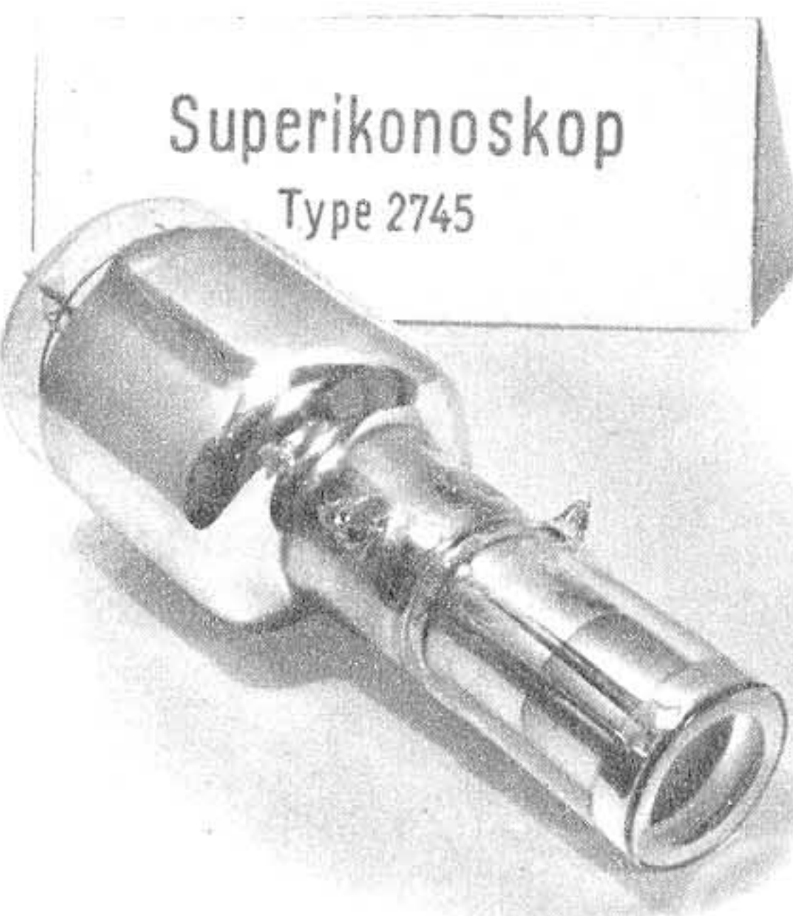
Superikonoskop für Fernseh-kameras und links Netzvervielfacher mit elektronenoptischer Abbildung der Foto-katode, zwei Entwicklungen des Fernmeldewerkes „HF“
